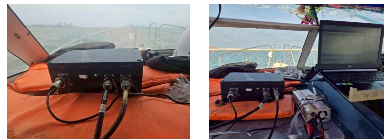
รูปที่ 5-8 ต่อพ่วงอุปกรณ์ GPS และ ECHO SOUNDER เข้ากับ COMPUTER
