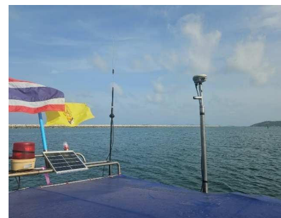
รูปที่ 5-1 เครื่องหาพิกัดด้วยดาวเทียม GNSS
