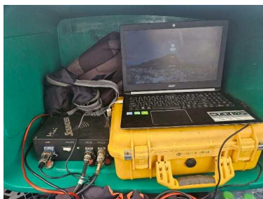
รูปที่ 5-3 เครื่องหยั่งน้ำ SBES Knudsen Mini Sounder
