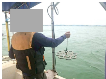
รูปที่ 5-9 ตรวจสอบค่าความลึกของเครื่อง ECHO SOUNDER
