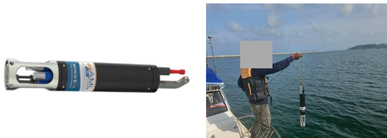
รูปที่ 5-12 เครื่องตรวจวัดกระแสน้ำ Sound Velocity Profiler
