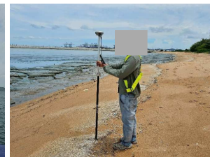
รูปที่ 5-1 เครื่องหาพิกัดด้วยดาวเทียม GNSS
